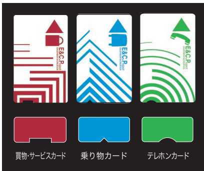
図2 JIS規格になった切り欠き形状
